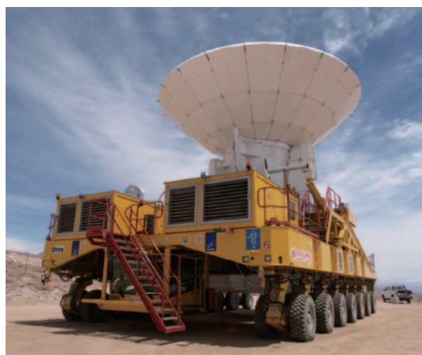
アンテナ専用移動台車(トランスポーター)で運ばれる パラボラアンテナ
