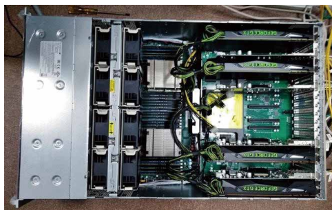
図 5.21 : GPU 分光計のプロトタイプ。4 枚の GPU カードと 2 枚のデータ取得カードを収めている。
