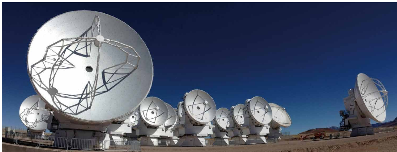
図 5.1: 日本が製造したアタカマコンパクトアレイ (Atacama Compact Array, ACA) の 12 メートルアンテナ (手前) と 7 メートルアンテナ (奥)。
