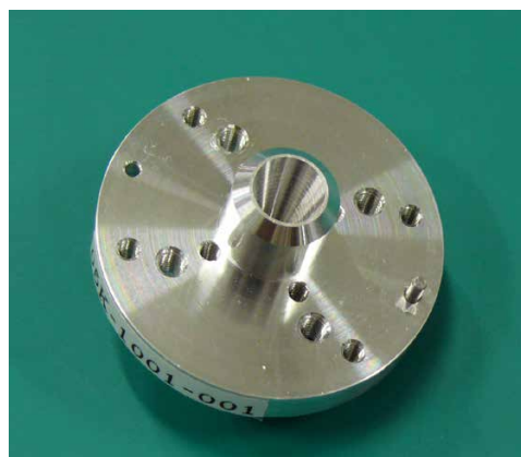
図 5.7：切削加工で作製したバンド 10 用コルゲートホーンアンテナの写真。開口部の直径は 6mm、円錐型の穴は 54 \mu\text{m} である。
