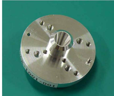
図 5.7: 切削加工で作製したバンド 10 用コルゲートホーンアンテナの写真。開口部の直径は 6mm、円錐型の穴は 54 μm である。
