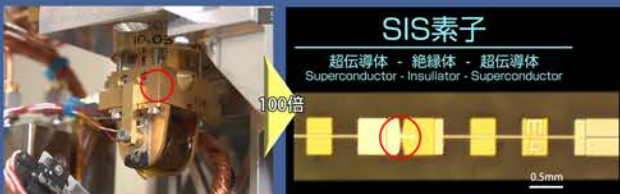
▲-269℃の冷却容器に10本の受信機を収める計画
