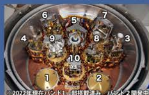
▲-269℃の冷却容器に10本の受信機を収める計画
